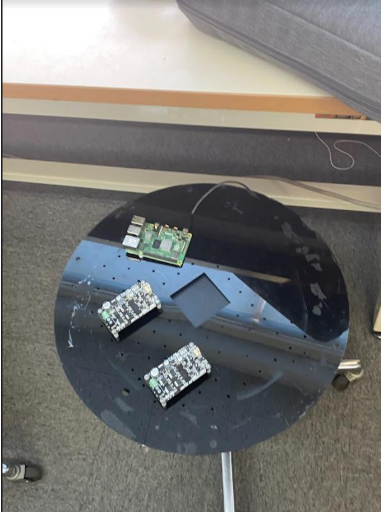
モータードライバ2つと raspberry pi を取り出した
